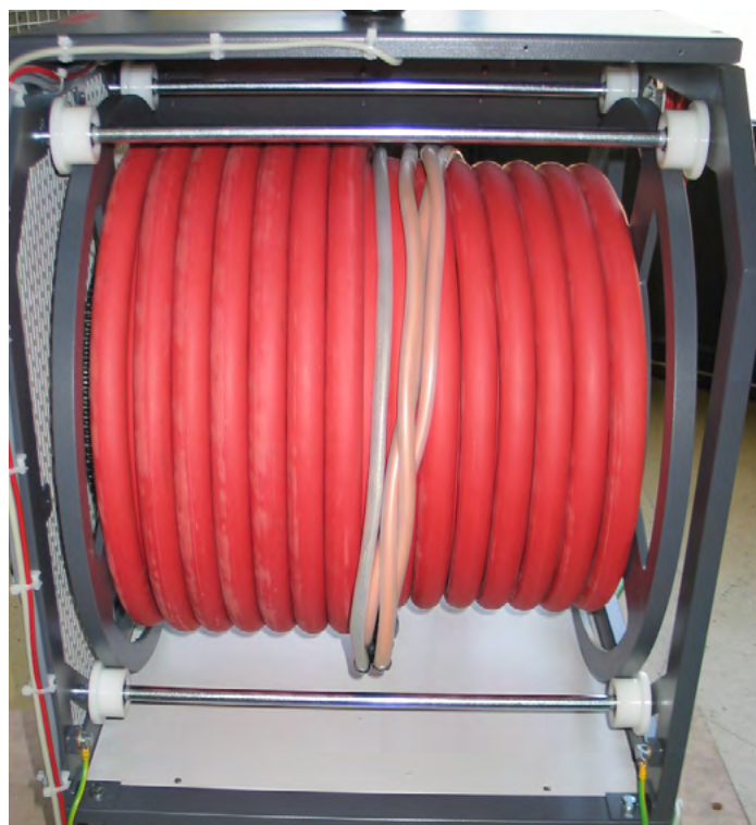
Motorbetriebene Kabeltrommel - Mehrleiterkabel für 3-phasigen Centrix ohne TE-Diagnose
